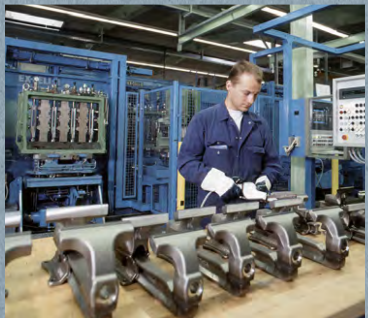
Έλεγχος ποιότητας στο κέντρο επεξεργασίας
